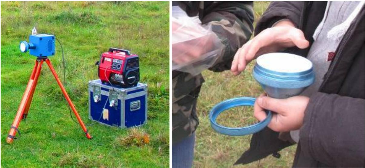
Рисунок 7 – Портативная ФВУ модели Н-810 (слева) и фильтр – фильтровальное полотно Петрянова (ФПП 15-1,5) (справа).
