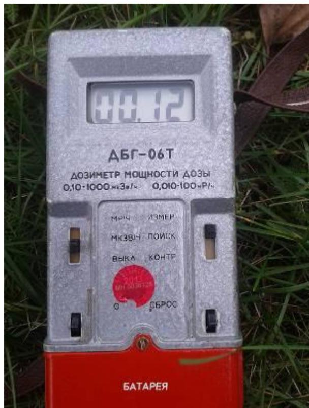
Рисунок 22 – Результат измерения уровня МД дозиметром ДБГ-01-Т в месте отбора проб почвы в г.Островец.
