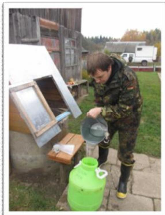
Рисунок 18 – Отбор проб грунтовых вод из колодцев в н.п.Трокеники, д.29 (слева) и д.47 (справа)
