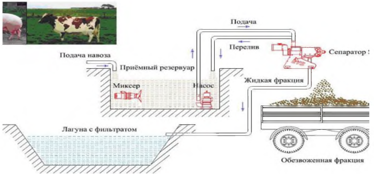
Рисунок 5. Примерная схема сепарации побочных продуктов животноводства.
