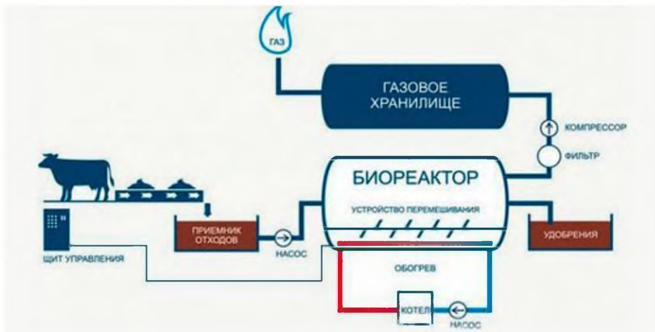
Рисунок 6. Примерная схема получения биогаза из навоза (помета).
