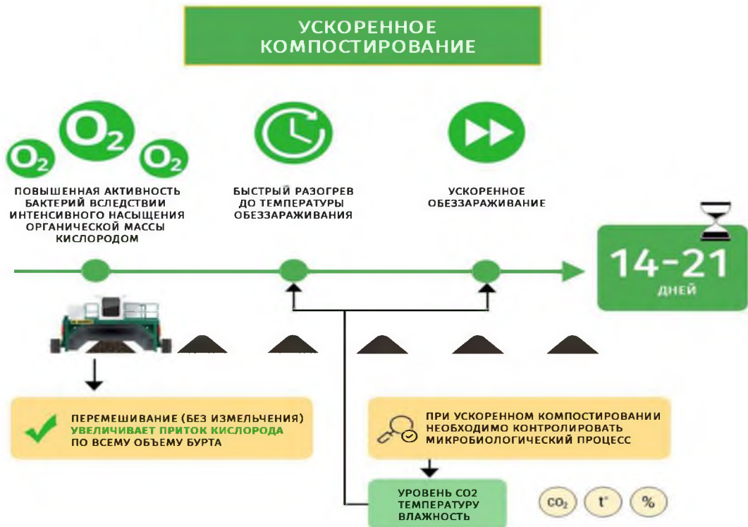
Рисунок 4. Примерная схема компостирования побочных продуктов животноводства на установках ускоренного компостирования.
