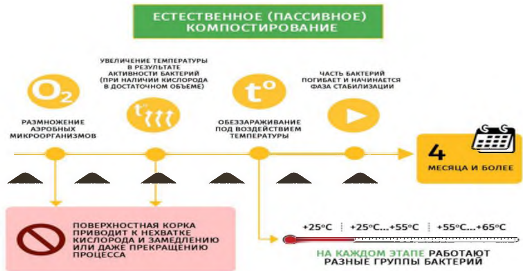
Рисунок 3. Примерная схема естественного компостирования побочных продуктов животноводства.
