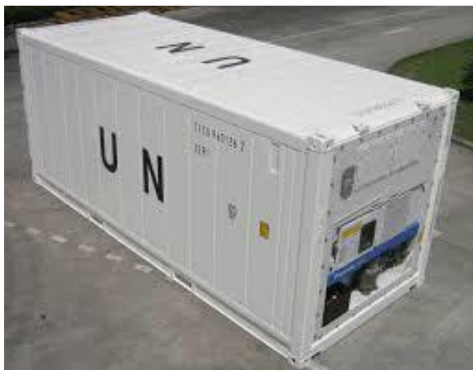
Холодильный контейнер для смешанной перевозки грузов со специализированной системой охлаждения
