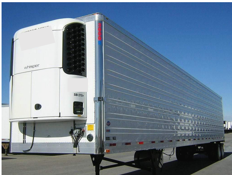
Прицеп-рефрижератор со специализированным дизельным двигателем и системой охлаждения
