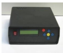
измеритель концентрации приземного озона на основе ПГС (NiO)
