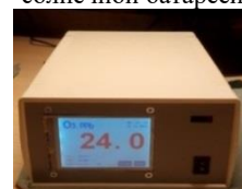
измеритель концентрации приземного озона на основе ПГС (SnO 2 )
